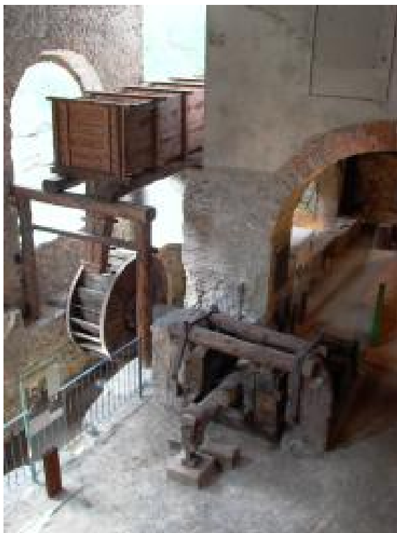
Ruota idraulica per il funzionamento del maglio
