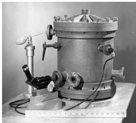
Fig.2: l'apparato sperimentale utilizzato da Millikan.
